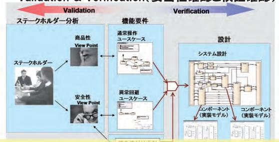
Validation:「正しいシステム」の確認、Verification:システムの「正しい設計」の確認
