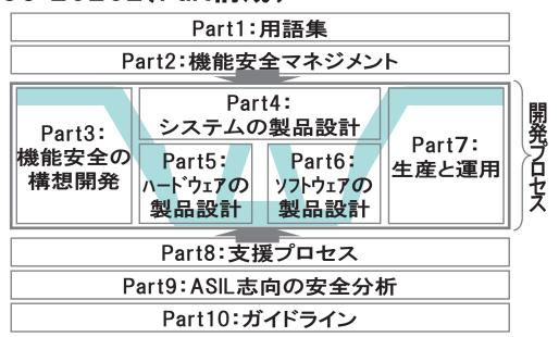
V字プロセスモデルと関連するマネジメント・プロセス・技法で構成
