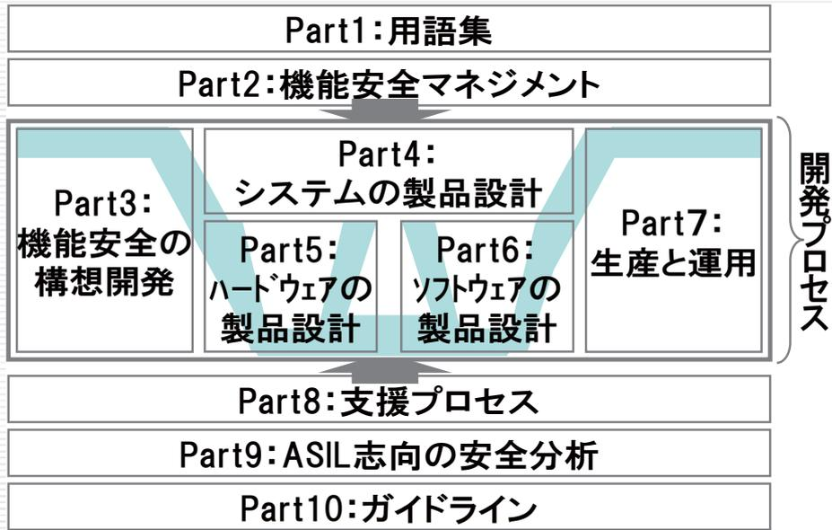
V字プロセスモデルと関連するマネジメント・プロセス・技法で構成
