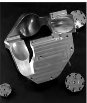
(株)蒲郡製作所：アルマ電波望遠鏡のミラーブロック
