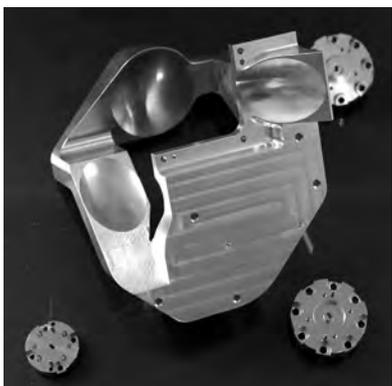
アルマ電波望遠鏡のミラーブロック
